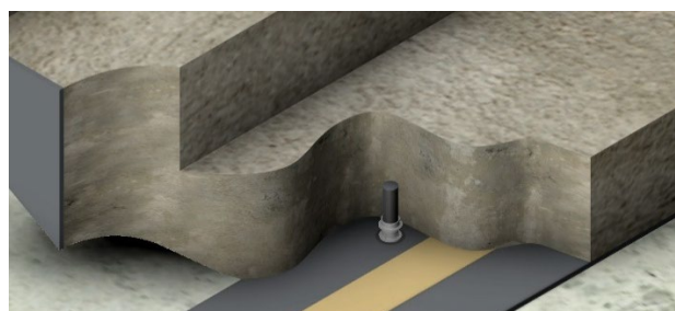
Położenie trzpienia FS-D w schodach prefabrykowanych
