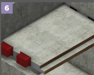
Betonowanie płyty spocznika
