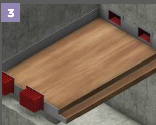
Montaż izolacji akustycznej FS-K
